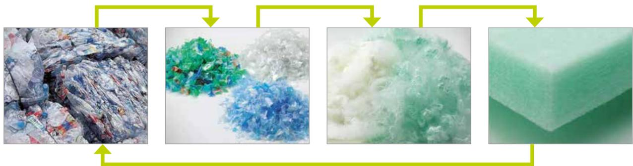
La fibre de polyester est obtenue à partir de la collecte et du traitement des bouteilles en PET. Après un procédé de thermoreliure, elle donne naissance à une mousse absorbante, mousse recyclée et recyclables à 100%. Elle ne contient aucun additif ou agent liant différent, par rapport au polyester.
